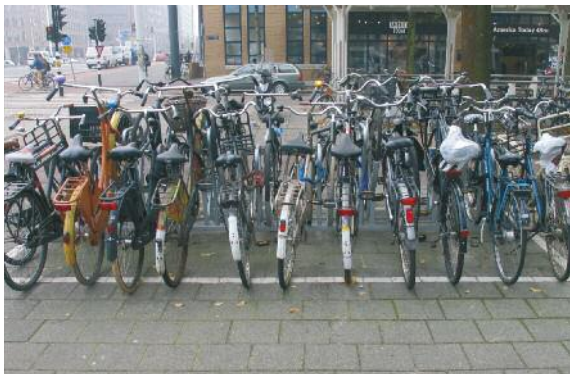
Weesperplein Amsterdam. Efficiënt gebruik van hoog/laag rek. Minder ruimtegebruik dan nabijgelegen leunhekken en de fietsen staan netter en stabiel!
