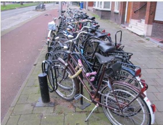
Schuinopstelling laag/laag bij woningen. Voldoet goed door schuine plaatsing en doordat het alleen te bereiken is via de stoep. Wel kun je makkelijk fout parkeren tussen fietspad en rek.
