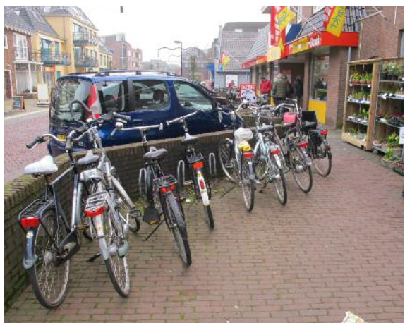
In alle opzichten slechte fietsenstalling bij supermarkt. Niet alleen het rek, maar ook te weinig plekken en fietsers hinderen voetgangers. Aanrijroute gaat ook via voetgangersgebied. Ruimte genoeg als de paar (overbodige) autoplekken verdwijnen.
