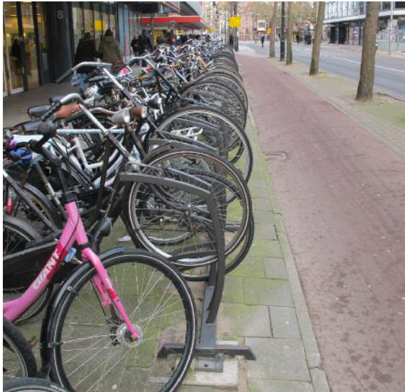
Jacobsstraat Utrecht: Zeer net geplaatste fietsen in hoog/laag rek. Dit is wel een rek met voorvorksteun!
